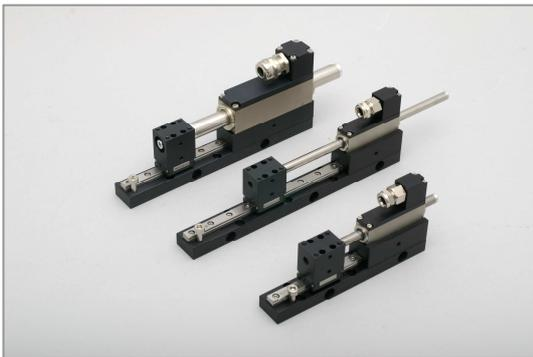
QM01 QuickDynamic® Linearmotor-Module sind mechanische Systeme, in die QuickShaft® Servoantriebe integriert sind. Mit ihren niedrigen bewegten Massen, hohen Tragzahlen und hohen Momentenbelastungen ist die einfache mechanische Integration der Linearantriebe in die Applikation möglich. Besonders bei engen Platzverhältnissen ist die schmale Baubreite von nur 20 mm vorteilhaft.
