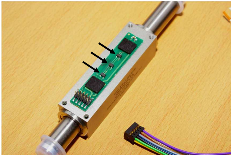
Hallsensoren zur Abtastung der Antriebsmagnete
