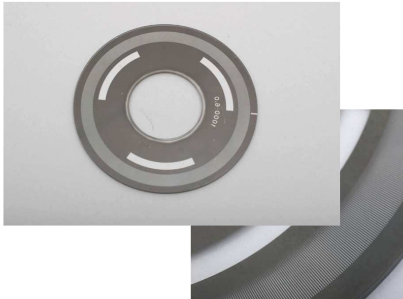
Codierscheibe eines optischen Inkrementalgebers mit Kommutierungs-, Inkrementalgeber- und Nullpunktspur (von innen nach außen)
