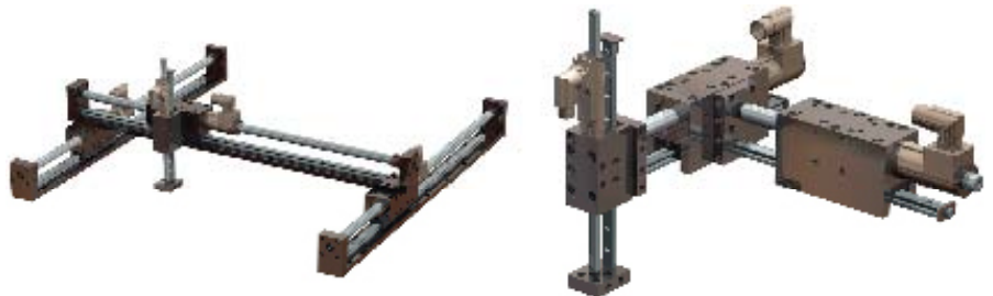
Varianten von Gantry-Anordnungen: Vergleichsweise hohe Massen determinieren hier die Taktraten. (Fotos: Jung)
