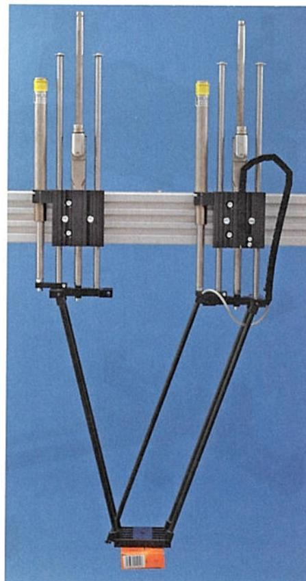
2: Das erste ParaPicker-Modell war in 2-achsiger X-Z-Parallelkinematik ausgeführt
