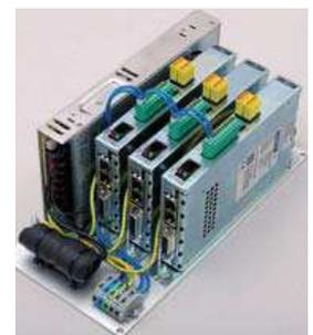
Platzsparendes Positioniercontroller-Paket: Kompakte PosiPac-Einheit von Jung Antriebstechnik u. Automation (JA<sup>2</sup>) in einer PC-05-Konfiguration mit einem Netzteil (links) und drei Controllern zur Ansteuerung von drei Achsen.
