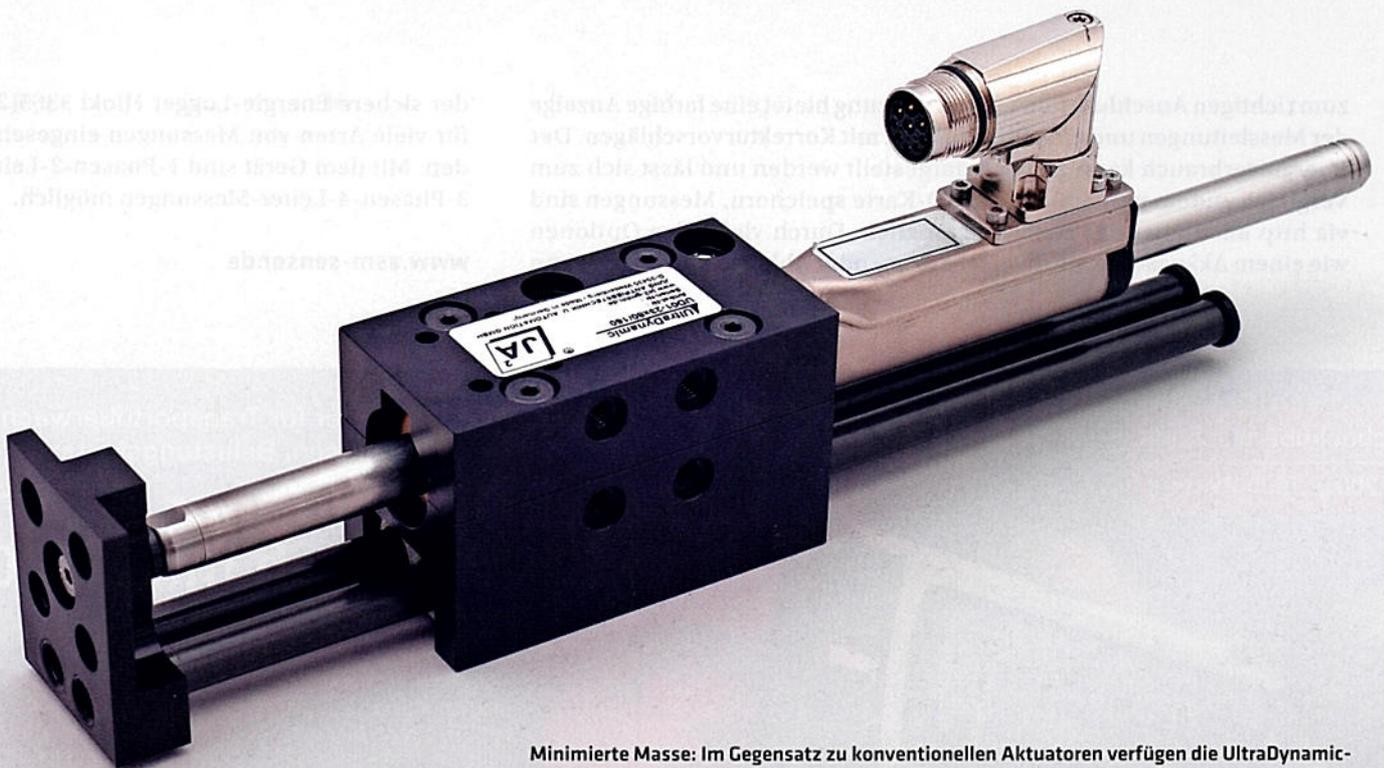
Minimierte Masse: Im Gegensatz zu konventionellen Aktuatoren verfügen die UltraDynamic-Linearmotor-Module der Baureihe UM01 von Jung sowohl über Führungskörper als auch über Stirnplatten aus CFK sowie über Gleitführungen aus verschleißfestem Spezialkunststoff. Foto: Jung
