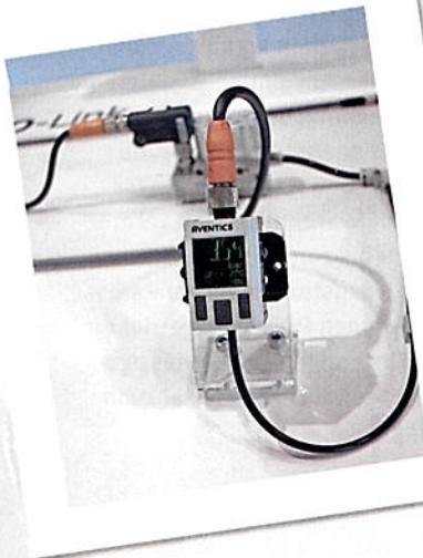
Wie sich Aventics intelligente Pneumatik vorstellt, zeigte das Unternehmen u. a. mit Systemkomponenten zur Selbstdiagnose und mit automatisierten Steuerungen sowie mit den Maschinensicherheitslösungen. Hier ist ein Drucksensor der PE5-Serie mit einer I/O-Link-Schnittstelle, die enorme Vorteile im Bereich Parametrierung und Vernetzung der Maschinenkomponente bietet. Foto: Erik Schäfer www.aventics.com
