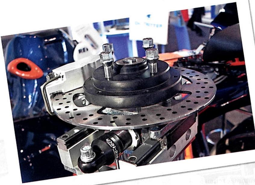
Diese martensitischen, schwarzverchromten Edelstahl-Profilbahnenführungen von Dr. Tretter werden in den Radaufhängungen für die Motorradgespanne von Ruko erfolgreich eingesetzt und trotz Schmutz, Wasser und Schwingungen.
