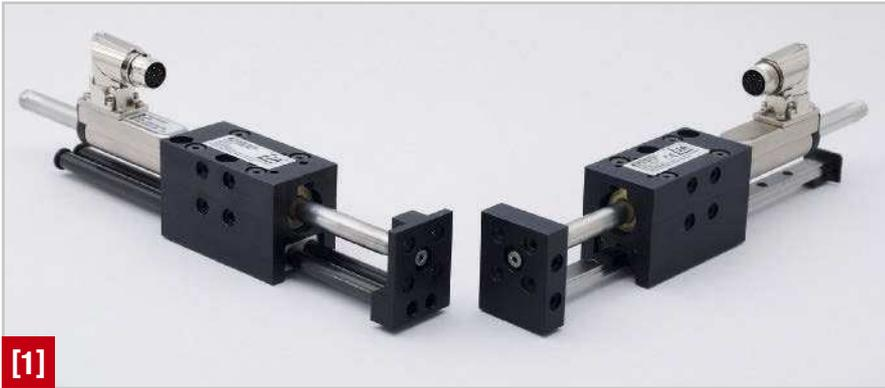
[1] Wenn jedes Gramm zählt: Die Baureihe Ultra-Dynamic (links) bringt aufgrund der CFK-Technologie mit Gleitführung 50 g bewegte konstruktive Masse auf die Waage. Zum Vergleich: Mit klassischer Kugelumlaufführung beträgt die Masse 263 g.
