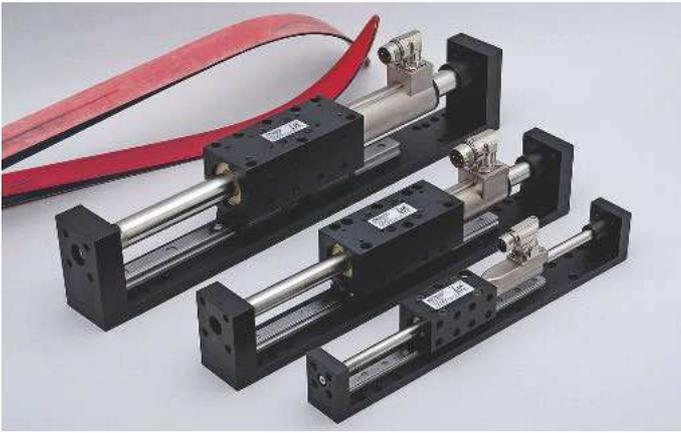
Dank ihres Hubweges von bis zu 1690 mm, Beschleunigungen von bis zu 150 m/s<sup>2</sup> und Spitzengeschwindigkeiten von 5,0 m/s eignen sich die Langhub-Linearachsen HA01 für schnell taktende Langhub-Anwendungen
