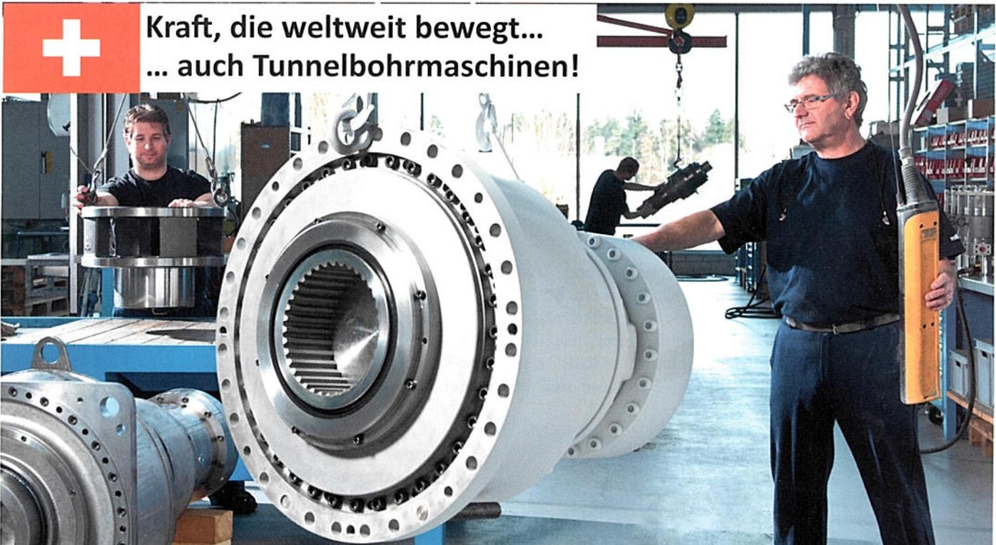
**Rollstar** gilt seit 1966 weltweit als kompetenter und verlässlicher Partner in der Antriebstechnik. Mit grosser Erfahrung im Getriebebau und den Fähigkeiten in Entwicklung, Konstruktion und Fertigung von Antriebsaggregaten werden Getriebe für Drehmomente von **1'500 bis 6'000'000 Nm** realisiert. Eine grosse Bevorratung aller Standardkomponenten bietet Gewähr für extrem kurze Lieferzeiten.
