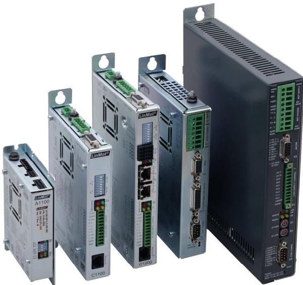
Die passenden Positioniercontroller beinhalten den Wechselrichter, die Bahnsteuerung und die Schnittstellen zu übergeordneten Steuerungen. Mit den Positioniercontrollern lassen sich einfache Punkt zu Punkt Bewegungen für die Handhabungstechnik, aber auch komplexe Bewegungskurven realisieren. Gängige Feldbusschnittstellen und parallele I/O's ermöglichen die einfache Anbindung an übergeordnete Maschinensteuerungen.
